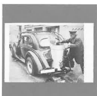
[87] Not macht erfindersch, Personenwagen mit Holzvergaser, aus 471
